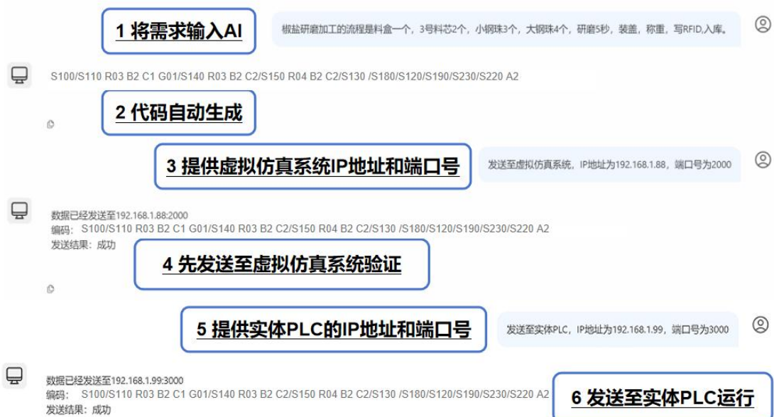
图 23 椒盐研磨加工工序工艺代码生成及验证
