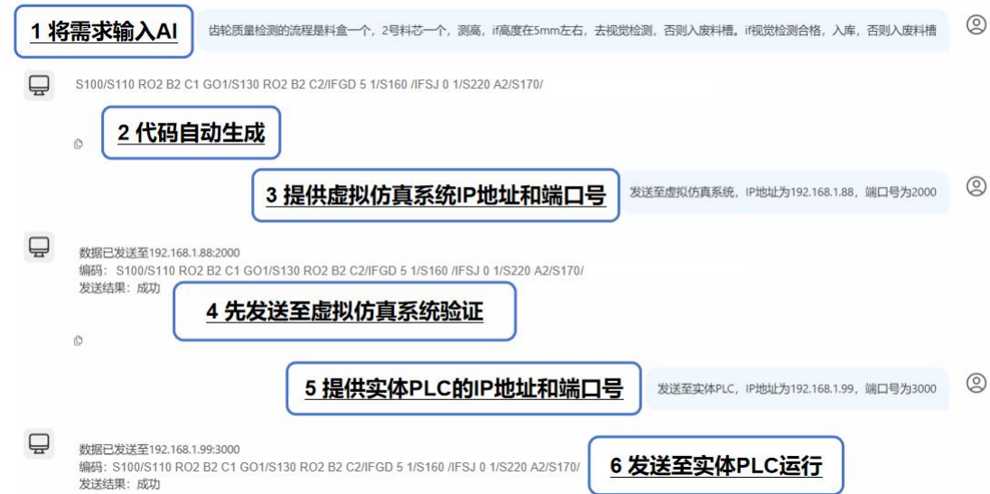
图 21 齿轮质量检测工序工艺代码生成及验证
