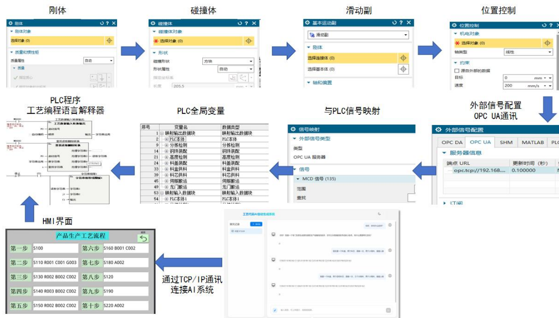
图 17 虚拟仿真系统验证工艺编程语言的方案框图
